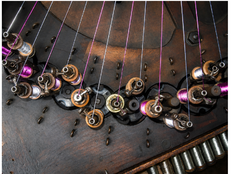
Photographie de fuseaux réels en action sur un métier, montrant les fils tendus en éventail convergeant vers le point de tressage.
